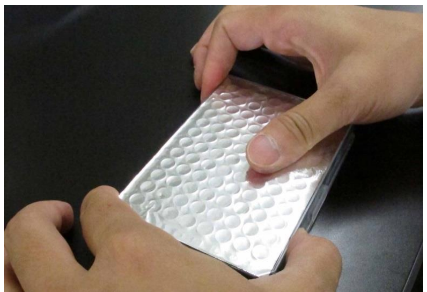
Fig.5 Wellの縁が確認できるまで圧着
