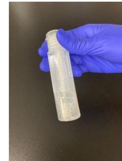
2) ふき取った綿棒をボトルに戻し、キャップを締めてよく振り混ぜます。これが、検査試料になります。
