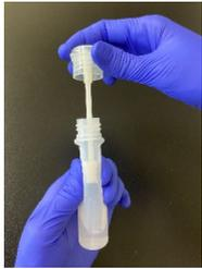
キャップをはずしてボトルの中央部で綿球部分を指で圧迫し、余分な水分を取り除きます。
