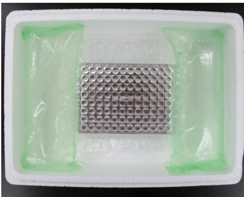
Fig.8 緩衝材を敷き詰める
